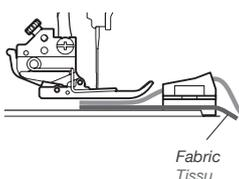
4. Faites glisser le tissu sous l'accessoire et le biais à l'arrière de la position de piqûre de l'aiguille.
