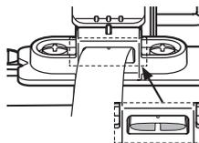
2. Faites passer le biais dans le guide pour biais avec le côté plié placé vers le bas.
