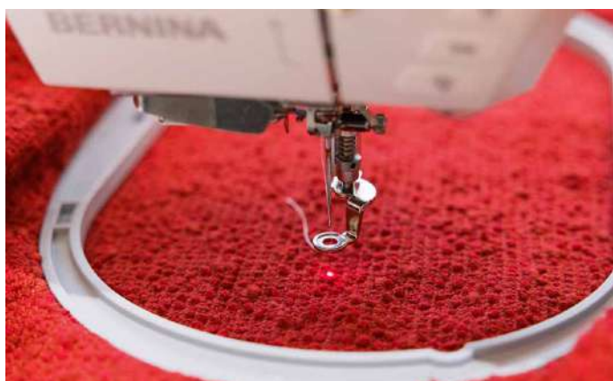
Placement exact grâce au pointeur laser
