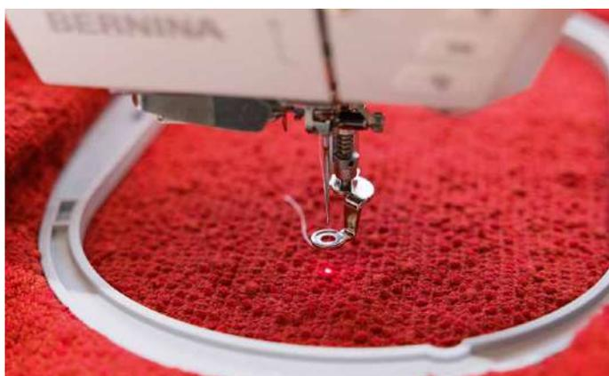
Placement exact grâce au pointeur laser
