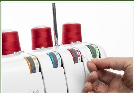
Tensions simples intégrées du fil et les chemins d'enfilage à code couleur rendent l'enfilage facile.
