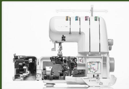
Les capots avant gauche et droit s'ouvrent pour permettre un **accès complet à la zone du boucleur**, ce qui facilite grandement l'enfilage.
