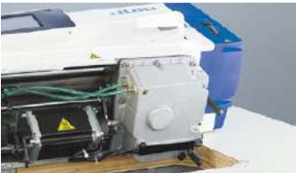
Bac à huile en aluminium moulé sous pression
