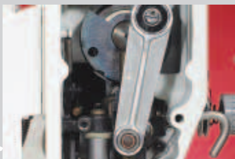
Une machine pour les matières fines et grosses : élévation modifiable de la barre à aiguille
