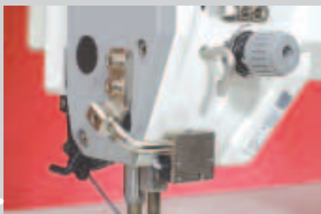
Cellule photo-électrique -971/03 (en option) pour la détection du bord arrière de la matière
