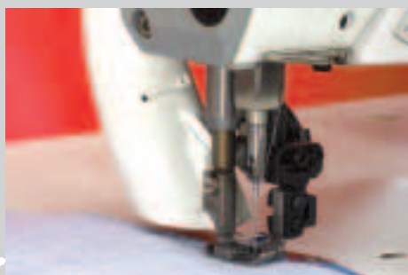
+ Couteau-raseur -731/01 avec dispositif d'aspiration (en option)
