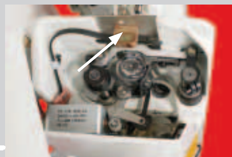
+ Contrôleur fonctionnel du fil de canette -926/06, avec détection du fil restant (en option)
