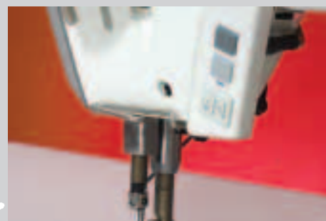
Triple touche à portée de main de l'opératrice : - Marche avant/arrière - Levée de l'aiguille sans coupe des fils - Inversion/activation des arrêts - Touche d'enfilage
