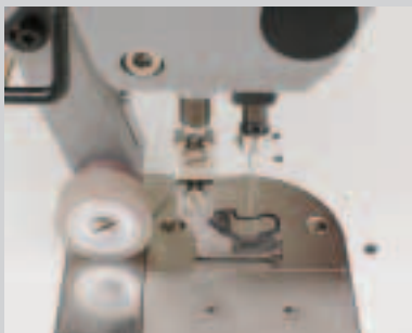
Puller avec pied et adaptateur
