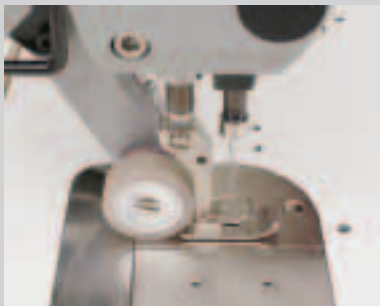
Puller avec pied standard (fermé)
